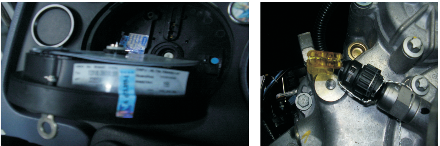
Figura 1 - Pontos de selagem do cronotacógrafo
